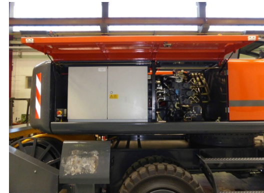
Schaltschrank und Verteilerblock
