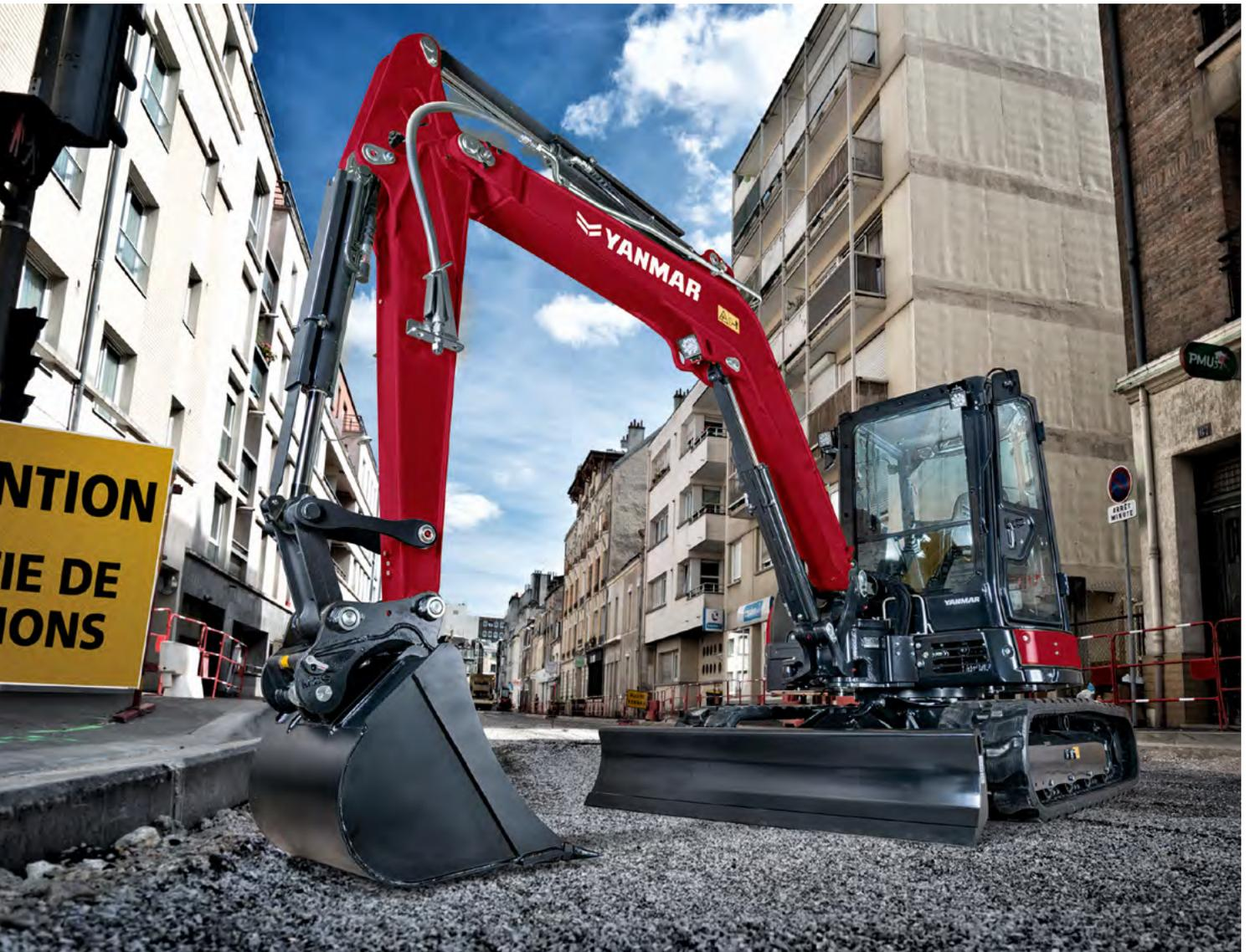
Dank eines verbesserten Antriebsstrangs, bestehend aus einem leistungsstärkeren Motor der Stage V mit DPF, einer um 14 % gesteigerten Leistung der Hydraulikpumpe und einem neuen Steuerventil, konnten die Zykluszeiten im Vergleich zum Vorgängermodell um mehr als 10 % verbessert werden.
